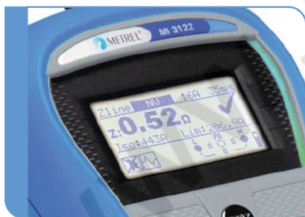
Duży ekran LCD z podświetleniem i sygnalizacją DOBRY / ZŁY
